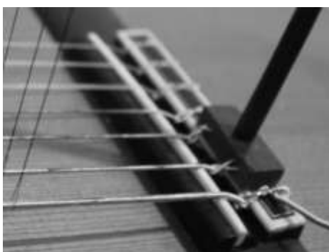
Figura 3. Base de madeira para sustentação da haste
