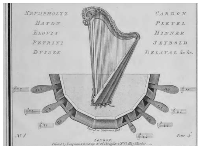
Figura 1. Harpa de pedais de ação-simples: destaque da capa de uma edição da “Longman & Broderip’s Selection of Music for the Pedal Harp” (Londres, c.1800). A figura destaca os pedais do instrumento e as notas obtidas com seu acionamento.
